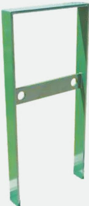
Einzelständer aus feuerverzinktem Flacheisen 50 x 12 mm oder 80 x 12 mm, mit mittig eingeschweißtem Flachstahl, hochkant, mit 2 Löchern Ø 40 mm, zum Befestigen der Fahrräder mittels Kette.
